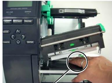
Achtung: Das Metall eines Ringes kann die Druckkopfkante beschädigen.
