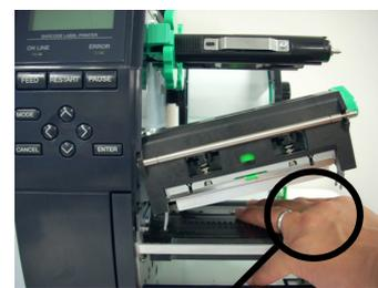
Achtung: Das Metall eines Ringes kann die Druckkopfkante beschädigen.
