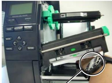
Achtung: Das Glas oder Metall einer Uhr kann die Druckkopfkante beschädigen.
